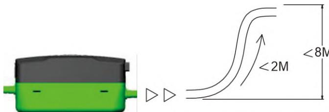
6.8 Подсоедините силиконовую трубку к выходному патрубку и зафиксируйте место соединения с помощью стяжки. Убедитесь в том, что высота подъёма воды не превышает 2 метра а длина силиконовой трубы не превышает 8 метров.
