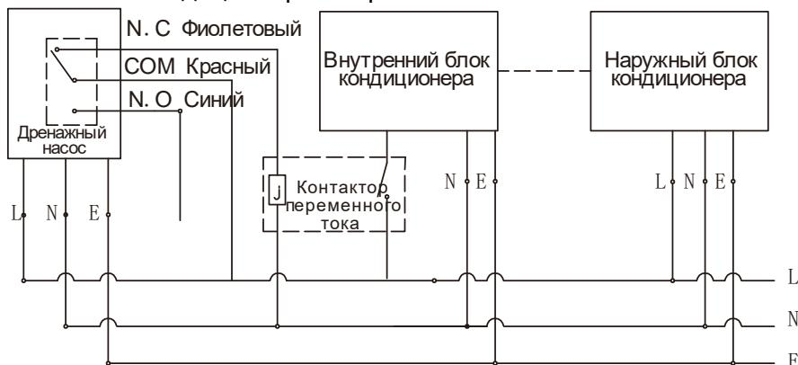
Если в кондионере отсутствует контроллер уровня жидкости, то аварийную линию можно подключить к контактору переменного тока, для контроля питания кондионера.
