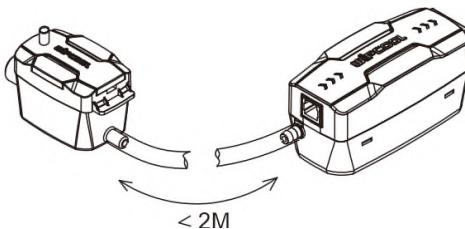
6.7 Соедините поплавок и качающий узел с помощью силиконовой трубы (идущей в комплекте поставки) и зафиксируйте концы трубы с помощью стяжек (идущей в комплекте поставки). Убедитесь что длина силиконовой трубы не превышает 2,0 метра.
