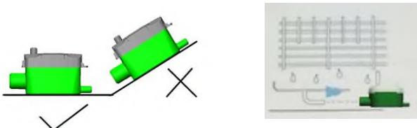
6.2 Убедитесь, что поплавок расположен горизонтально и патрубок соединяющий внутренний блок кондиционера и поплавок плотно соединена и не имеют течи конденсата
