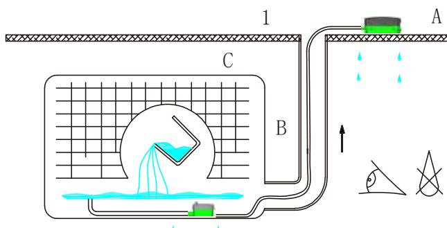
6.11 Налейте немного воды в дренажный поддон кондионера для того, чтобы проверить систему на отсутствие протечек и правильность работы дренажной помпы.
