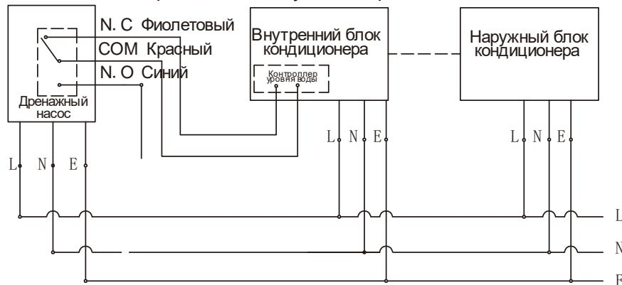
Если в кондионере отсутствует контроллер уровня жидкости, то аварийную линию можно подключить к другим аварийным системам кондионера см. рис. 2
