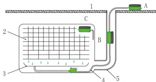
6.4 Установка качающего узла возможна как в коробе, так и над подвесным потолком
